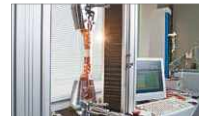
Испытания наконечников на разрывное усилие
