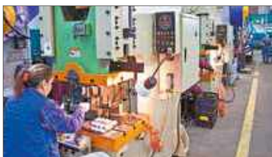
Производство болтовых соединителей и наконечников
