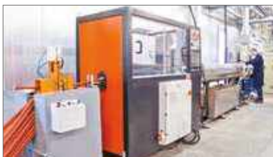
Линии для экструдирования термоусаживаемой трубки
