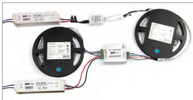
Примеры подключения усилителя мощности
