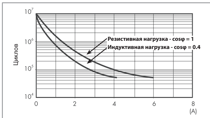
F 32 - Электрическая долговечность (AC) при ном. нагрузке
