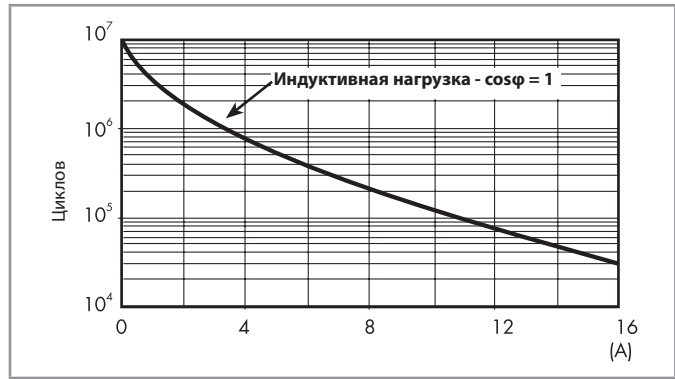
F 45 - Электрическая долговечность (AC) при ном. нагрузке тип 45.31/45.91
