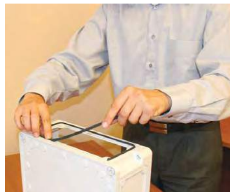
3. Установите уплотнитель на оба объединяемых корпуса
