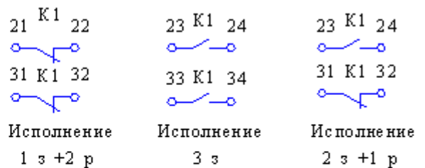
Рис. 2.4 - Пускатели неперевисные с реле со встроенными в оболочку кнопками управления типа ПМ12-010260, ПМ12-010220 (1"з")
