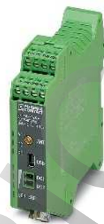
Bluetooth-преобразователь универсальный, для интерфейсов RS-232, RS-422, RS-485-2-проводной
