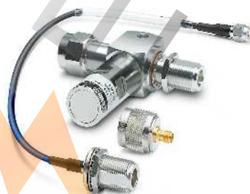
Для GSM-систем (0,8 ГГц – 2,25 ГГц), экран заземлен, подключение: SMA
