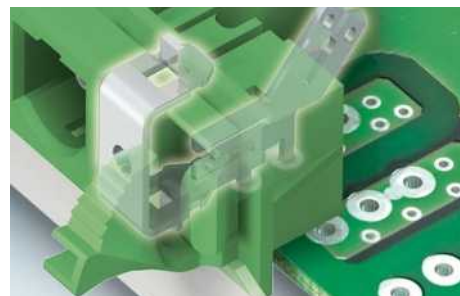
3 Проходное подсоединение экрана с помощью разъема исполнения STF-SH
