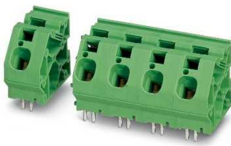
Шаг 15 мм, с контрольным отводом, возможность установки перемычек, UL-допуск на применение в цепях с напряжением 600 В
