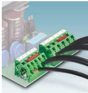
Серия ZFKDS 4: пружинные зажимы, до 32 А, шаг 7,5 / 10 мм ZFKDS 4... Стр. 477
