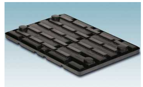
Крупногабаритные компоненты для сквозного монтажа методом пайки оплавлением припоя в лотке
