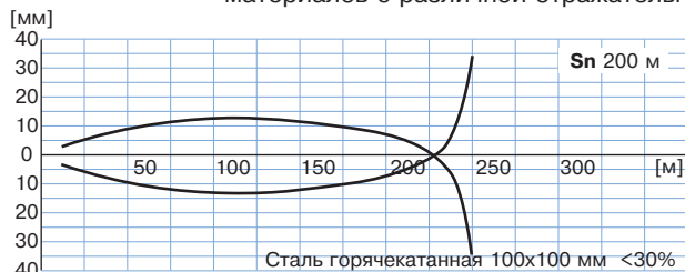
Тип D. Диффузный – Расстояние срабатывания при боковом подходе контролируемых объектов из материалов с различной отражательной способностью
