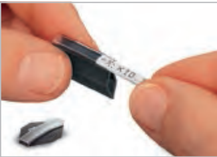
Вставьте маркер для плоттера в паз для маркировочного манжеты. Замена маркера возможна и после подключения проводника.
