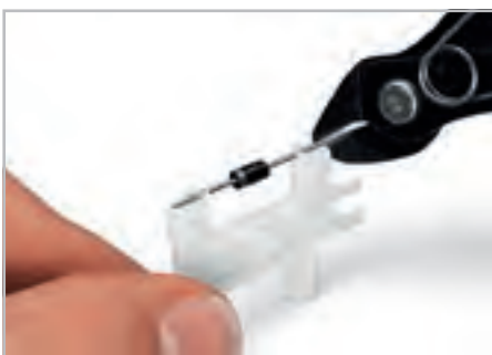
Обрезка компонента до необходимой длины.
