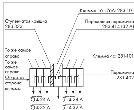
Объединение клемм от 16 мм 2 /AWG 6 (серия 283) до 4 мм 2 /AWG 12 (серия 281) для монтажа на рейку.
