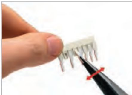
Перемычка «через один» на 7 контактов Отлом контактных лепестков – отдельные контакты перемычки могут быть отделены путем излома. Оставшаяся часть изоляции будет соответствовать требованиям по размеру зазора и пути утечки тока.
