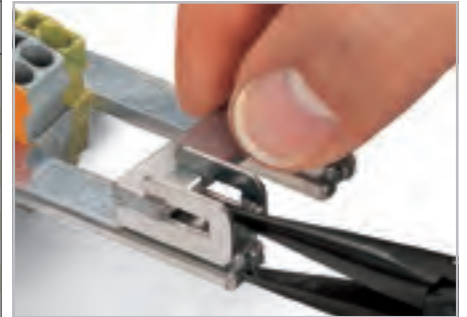
Для извлечения шины сожмите пружину с помощью плоскогубцев.
