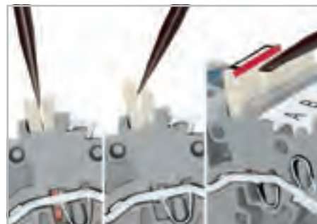
Снятие перемычки «через один» Вставьте рабочий инструмент между перемычками и поднимите перемычку.
