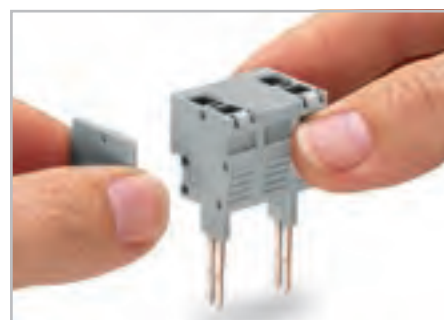
Сочленение соединителей и модулей разделителей с разделительной пластиной для сборки многоконтактного модуля тестового штекера (макс. 10 контактов).
