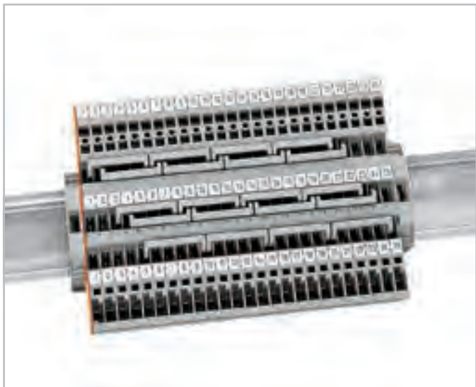
1-проводные/1-конт. базовые клеммы с 3 входами для перемычек 3 входа для перемычек позволяют использовать до 6 ступенчатых перемычек.
