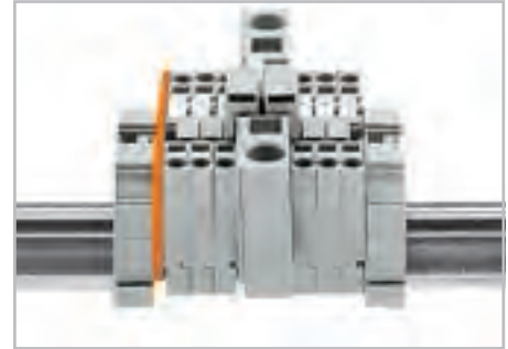
Объединение клемм от 16 мм 2 /AWG 6 (серия 283) до 4 мм 2 /AWG 12 (серия 281) для монтажа на рейку.
