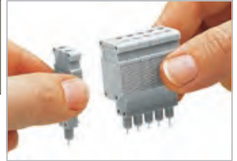
Соединение тестового штекера и модулей разделителей для сборки многоконтактного модуля тестового штекера (максимум 10 контактов).
