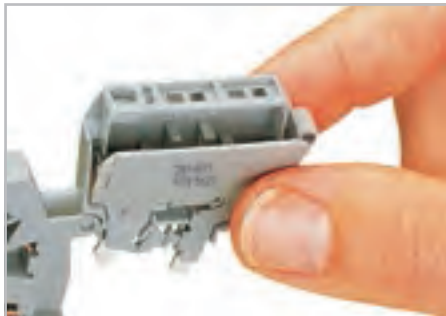
Вставьте новый предохранитель и закройте крышку.
