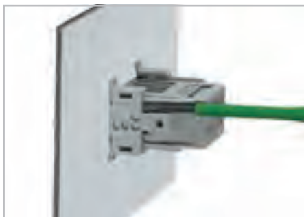
Для отсоединения вставьте рабочий инструмент (ширина лезвия 2,5 мм) в разблокирующий разъем.
