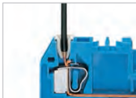
Упор-ограничитель позволяет избежать попадания изоляции проводника в зажим.
