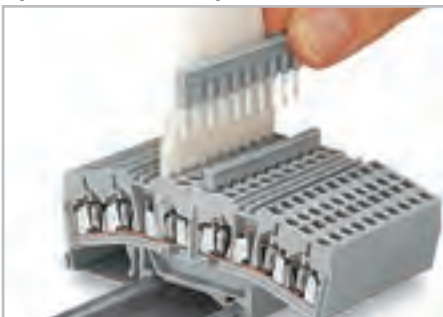
Используется для умножения потенциала. Установка 10-конт. перемычки «гребень» (возможно только в центре).
