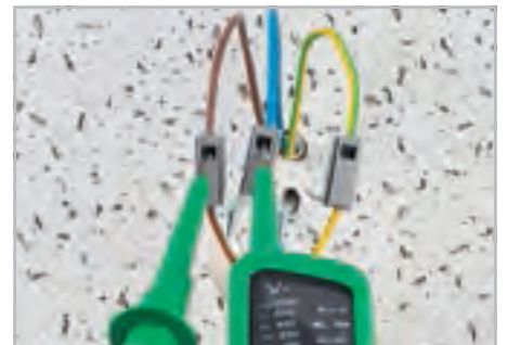
Измерение через отдельное тестовое гнездо.
