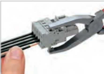
Заделка кабеля – боковой вход (в примере показана розетка).
