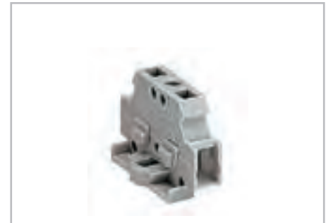
Клемма с крепежным фланцем, для винтового или аналогичного способа крепления, крепежное отверстие 3,2 мм Ø (с монтажным адаптером 209-123 также для DIN-рейки 35 мм) Возможность боковой маркировки с помощью маркировочной системы Mini-WSB Quick, тестовый разъем.
