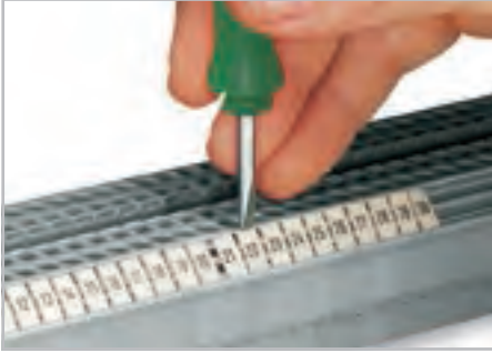
Установка полоску в паз для маркировки.
