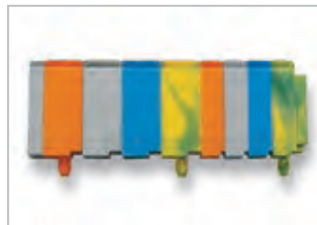
Клеммная колодка с опорными ножками, для пластин толщиной 0,6 ... 1,2 мм, крепежное отверстие Ø 3,5 мм
