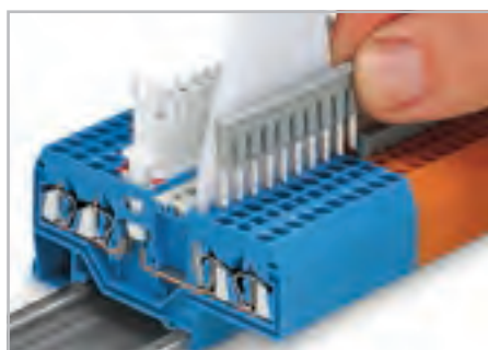
Объединение клемм с разъемником с фронтальным входом с помощью гребешковой перемычки с помощью 10-конт. рабочего инструмента.
