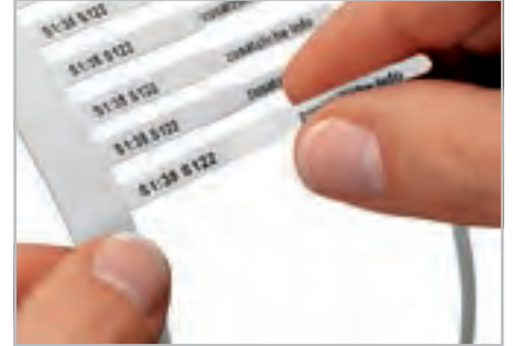
Удалите отпечатанный маркер из рулона.
