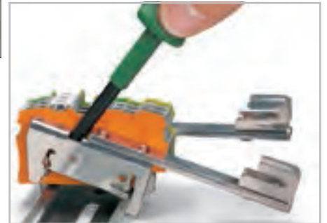
Снимите держатель шины с помощью рабочего инструмента, тип 3, лезвие 5,5 x 0,8 мм.
