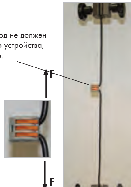
Схема испытаний для UL 486 C:
