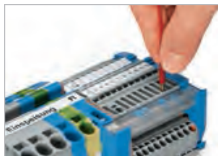
Проверка с помощью тестового штекера 2 мм Ø (макс. тестовое напряжение: 42 В)
