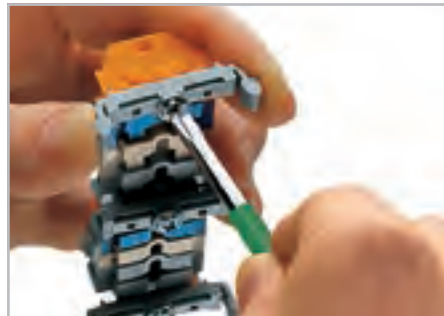
Клеммная колодка с крепежными фланцами, винтовой монтаж адаптера 209-123 (расстояние между адаптерами не должно превышать 35 ... 40 мм).
