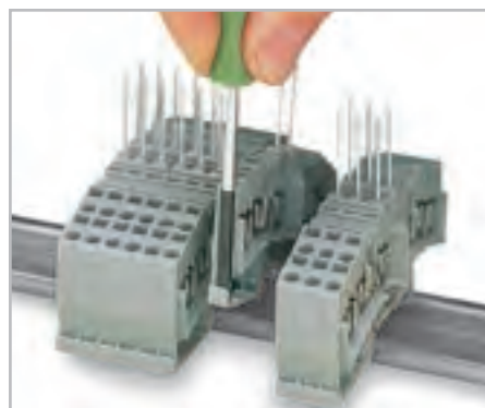
Удаление: отделите клеммную колодку, выдвиньте клемму, чтобы разъединить ее, а затем снять с рельса.
