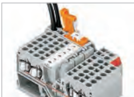
Ступенчатые перемычки для сложных схмотехнических решений. Всегда утапливайте перемычку до упора.
