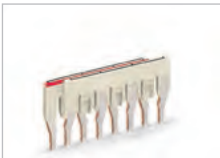
Перемычки, установленные в шлицы Это позволяет изготавливать специализированные перемычки «через один», напр., для соединения клемм с различным потенциалом. Убедитесь, что только один лепесток контакта соприкасается с клеммой.
