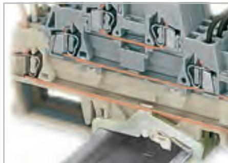
Клеммы с заземлением или экранированные клеммы имеют контактную опору на нижнем уровне, которая автоматически устанавливает контакт с несущим рельсом.
