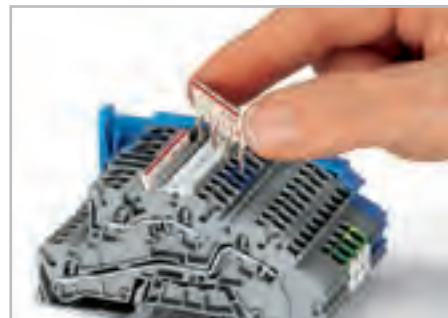
Вставьте перемычку «через один» Утопите перемычку до упора.
