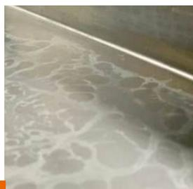
**Обезжиривание металла фосфатирующим составом на водной основе**
