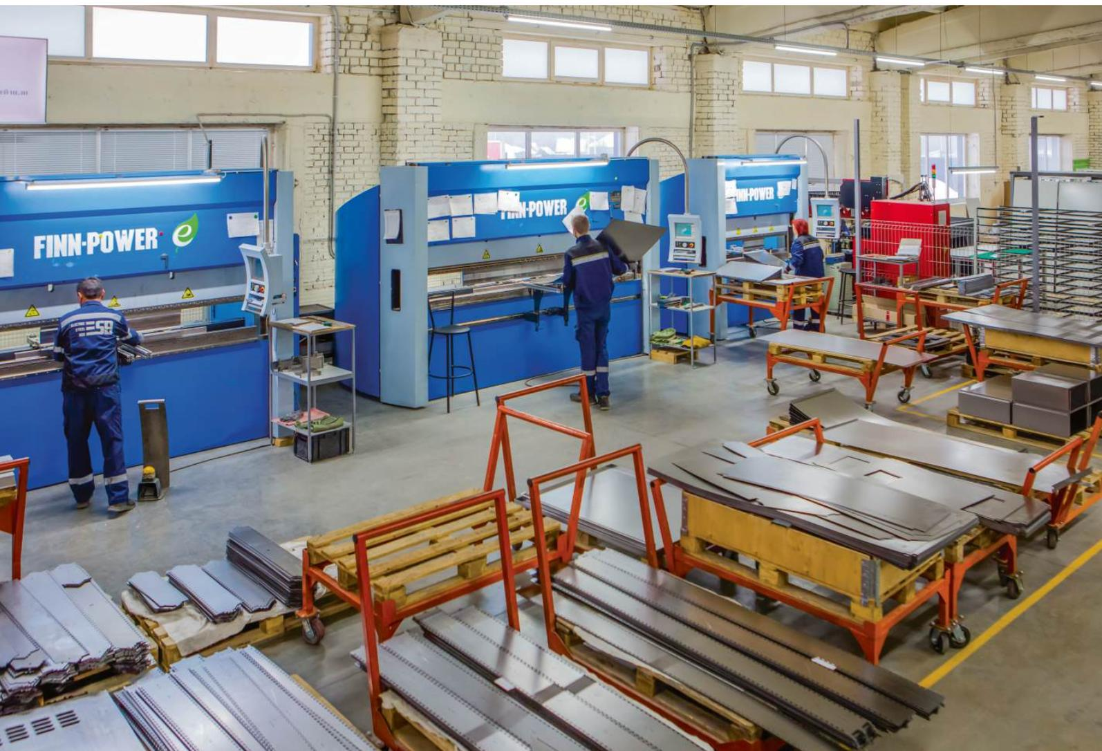
**Предприятие Electric Steel Vox имеет в оснащении 3 пресса FINN-POWER с системой ЧПУ, обеспечивающих максимальную длинугиба 1600 мм, 2550 мм и 3100 мм, зарекомендовавших себя как одни из самых быстрых, надежных и простых в использовании.**
