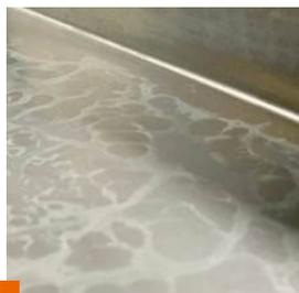
**Обезжиривание металла фосфатирующим составом на водной основе**
