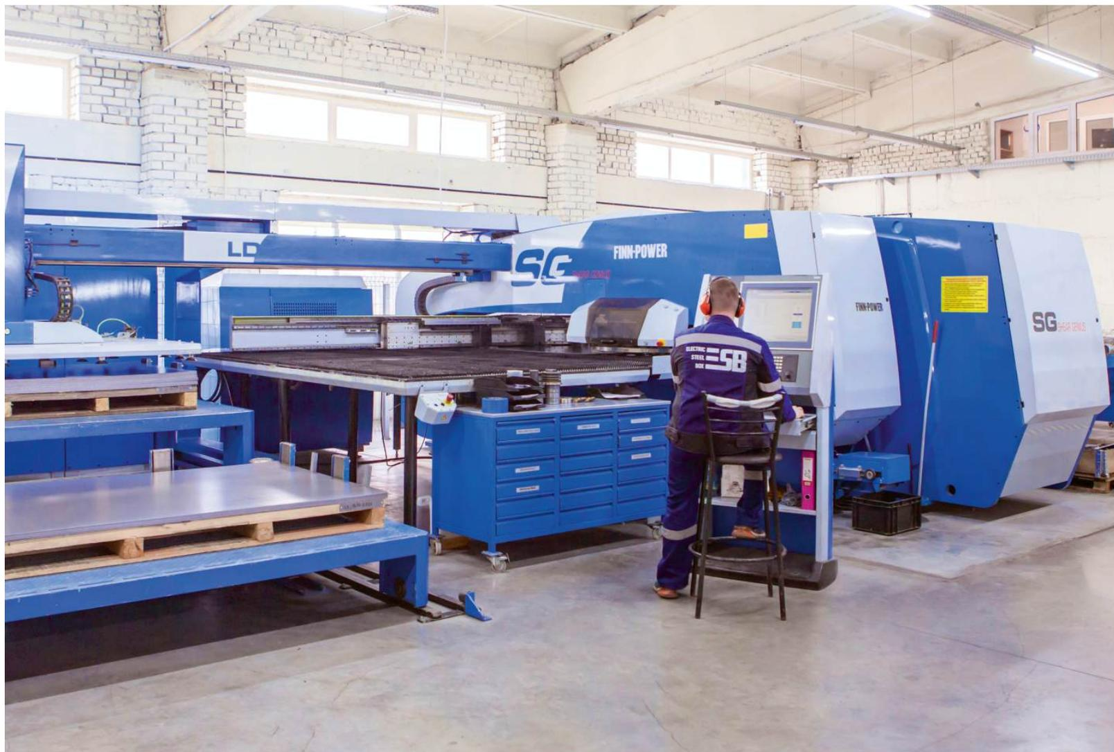
Предприятие Electric Steel Box имеет в оснащении станок FINN-POWER SG-6 - один из самых быстрых, точных, автоматизированных и надежных станков среди аналогов. Для работы и обслуживания станка требуется всего один оператор. После ввода программы, станок сам берет металл, рубит и сортирует по адресам детали в транспортировочную тару. В результате за короткое время из сырья в виде листового металла получаются готовые отсортированные детали для гибочного участка или конечной сборки.
