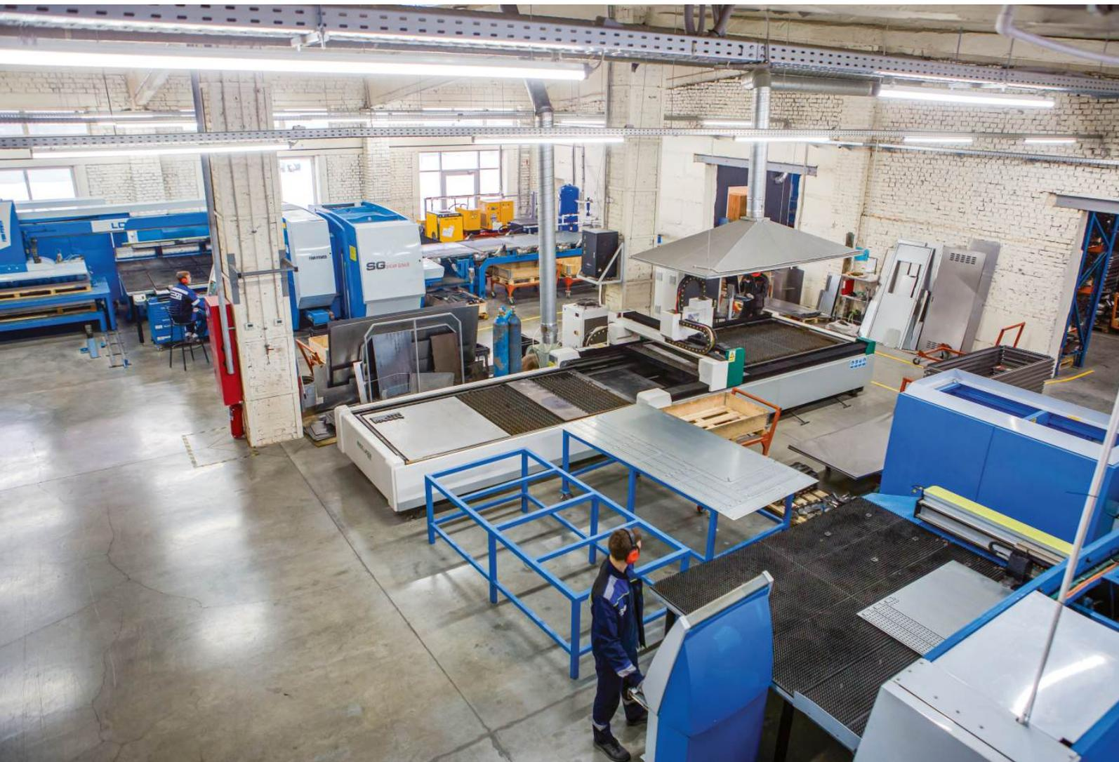
**Предприятие Electric Steel Vox имеет в оснащении лазерный станок серии TS1530H, обладающий высокой скоростью резки металла. При меньшем энергопотреблении скорость раскроя на этом станке в 2 раза выше чем CO2 лазера с одинаковой мощностью с более высоким потреблением энергии. Исполнение станка позволяет работать на нем в несколько смен в режиме 24/7.**
