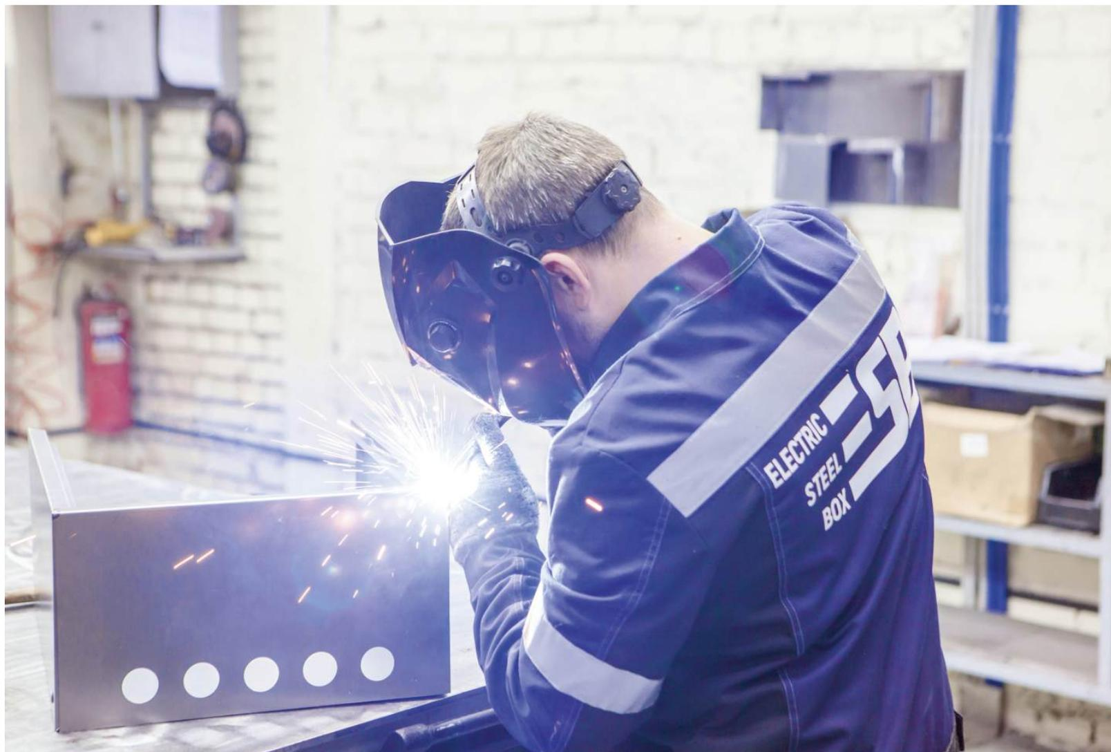
**Предприятие Electric Steel Box имеет в оснащении промышленные полуавтоматы, аппараты контактной, конденсаторной и лазерной сварки. Применяется оборудование, зарекомендовавшее себя на рынке как одно из самых производительных и надежных (Esab, Тесна, Has, IPG).**
