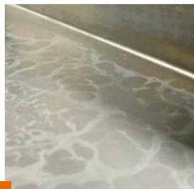
**Обезжиривание металла фосфатирующим составом на водной основе**
