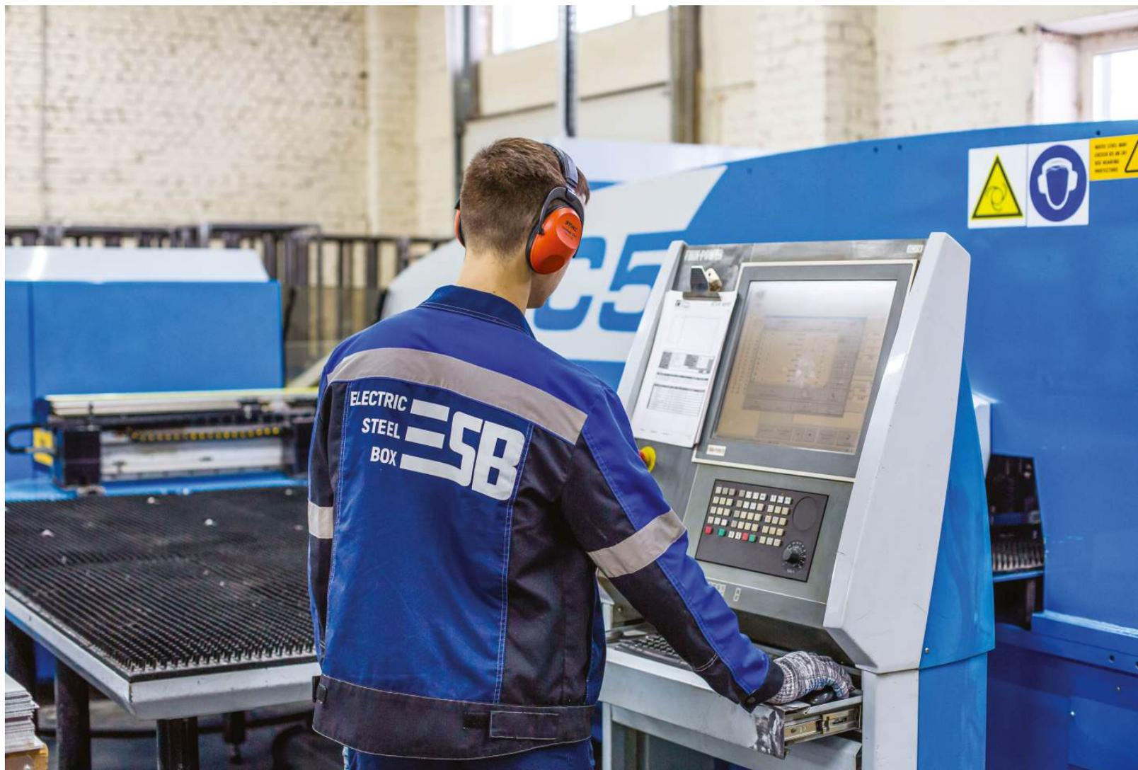
**Electric Steel Box имеет в оснащении станок FINN-POWER C5 с ЧПУ. Отличается от SG-6 отсутствием ножниц, модуля автоматической нагрузки и сортировочного конвейера. Однако оснащен более современной гидравликой и быстродействующей коробкой передач механизма индексации.**
