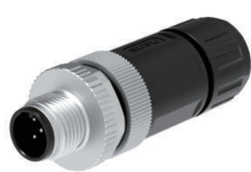
Штекерный прямой M12, в сборе (подключение на месте), неэкранированный, вывод под пайку
