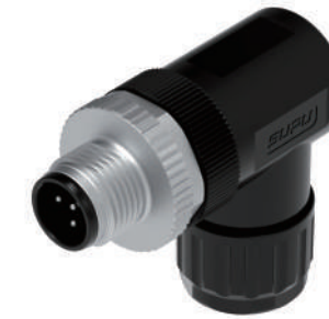
Штекерный угловой M12, в сборе (подключение на месте), незранированный, винтовой зажим
