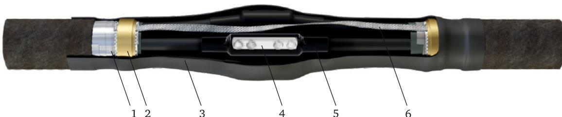
Муфты соединительные 3;4;5 ПСТ6 нг-LS, не поддерживающие горение (нг), с низким выделением дыма (LS) предназначены для соединения 3-4-5 жильных силовых кабелей с пластиковой или ЭПР изоляцией (ПВХ, сшитый полиэтилен, ЭПР) с броней на напряжение до 1 кВ. Данные муфты устанавливаются как в земле, так и на воздухе на вертикальных и других кабельных трассах.
