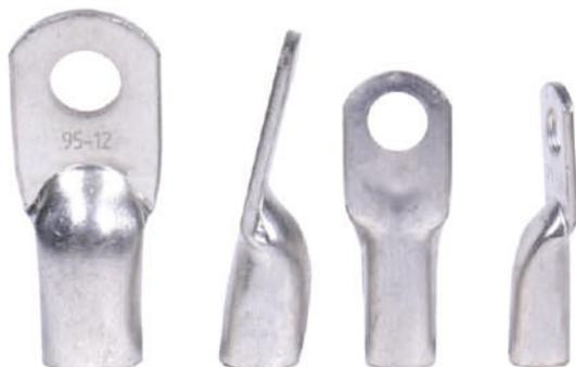
Наконечники кабельные медные лужёные ТМЛо используются для оконцевания проводов и кабелей с медными жилами сечением от 6 до 95 мм<sup>2</sup> и применяются для кабелей напряжением до 10 кВ. Наконечники закрепляются на жилах опрессовкой.
