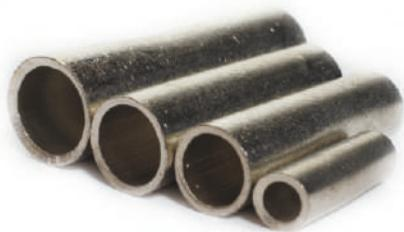
Гильзы кабельные соединительные медные луженые ГМЛ, закрепляемые опрессовкой, предназначены для соединения медных жил проводов и кабелей с сечением от 2,5 до 240 мм<sup>2</sup>. Гильзы медные лужёные применяются для кабелей напряжением до 10 кВ.
