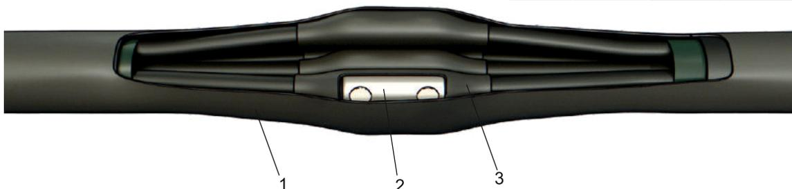
Муфты соединительные 3;4;5 ПСТ нг-LS, не поддерживающие горение (нг), с низким выделением дыма (LS) предназначены для соединения 3-4-5 жильных силовых кабелей с пластиковой или ЭПР изоляцией (ПВХ, сшитый полиэтилен, ЭПР) без брони на напряжение до 1 кВ. Данные муфты устанавливаются как в земле, так и на воздухе на вертикальных и других кабельных трассах.
