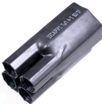
Термоусаживаемые перчатки ТУп с клеевым слоем на внутренней поверхности юбки и пальцев предназначены для изоляции герметизации «корня» разделки силового кабеля с бумажной маслопропитанной и пластмассовой изоляцией.
