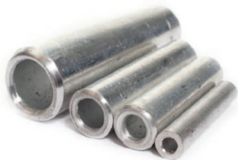
Гильзы кабельные соединительные алюминиевые ГА, закрепляемые опрессовкой, предназначены для соединения алюминиевых жил проводов и кабелей с сечением от 16 до 240 мм<sup>2</sup>. Гильзы алюминиевые применяются для кабелей с напряжением до 10 кВ.
