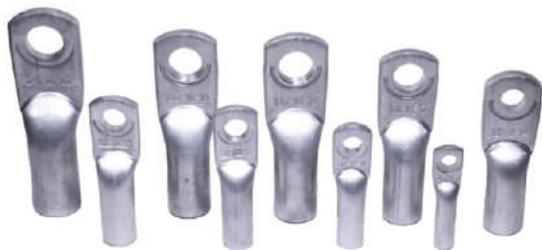
Наконечники кабельные алюминиевые ТА, закрепляемые опрессовкой, предназначены для оконцевания алюминиевых жил кабелей и проводов сечением от 16 до 240 мм<sup>2</sup> на напряжение до 35 кВ. Наконечник одевается на жилу кабеля и опрессовывается гидравлическим или ручным прессом. Такой метод жёстко скрепляет наконечник и жилу кабеля, обеспечивая надёжный контакт.
