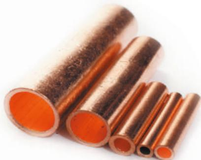
Гильзы кабельные соединительные медные ГМ, закрепляемые опрессовкой, предназначены для соединения медных жил проводов и кабелей с сечением от 2,5 до 240 мм<sup>2</sup>. Гильзы медные применяются для кабелей напряжением до 10 кВ.
