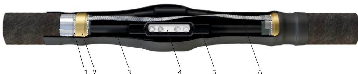
Муфты ПСТ-1; ПСТ6-1 предназначены для соединения 3-4-5-жильных силовых кабелей с пластиковой изоляцией (ПВХ, сшитый полиэтилен, ЭПР) с броней или без брони на напряжение до 1 кВ. Данные муфты устанавливаются как под землей, так и на воздухе на вертикальных и других кабельных трассах без ограничения разности уровней.
