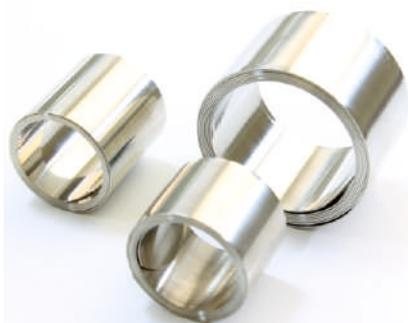
Пружины постоянного давления предназначены для присоединения провода заземления без применения пайки к металлической оболочке или бронелентами кабеля. Пружины ППД изготовлены из материала, не имеющего магнитных свойств.
