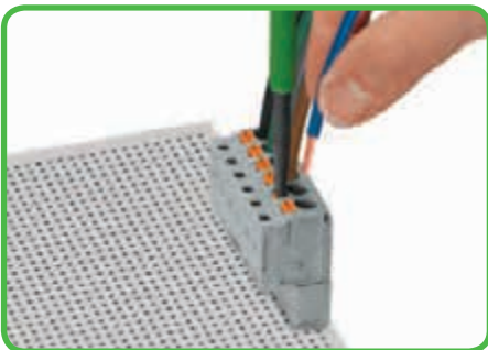
Вставка тонкожильного проводника в зажим CAGE CLAMP®S при помощи нажимной кнопки.
