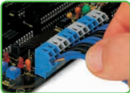
Монтаж одножильного проводника путем вставки в зажим.
