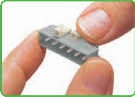
Кодирование вилки - установка ключа (-ей) кодировки.
