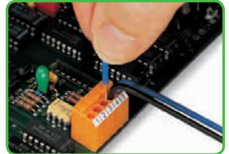
Монтаж упрощается простой вставкой проводника в зажим.
