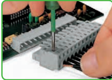
Вставка проводника при помощи 3,5 мм отвертки - открыть зажим CAGE CLAMP® перпендикулярно вводу проводника.
