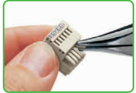
Кодировка розетки – выломайте кодировочный штифт (-ы).
