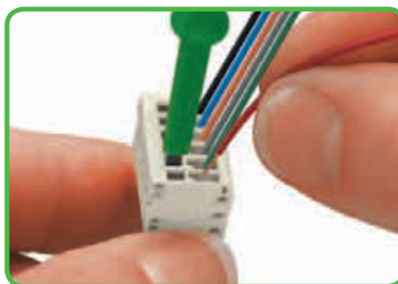
Вставка проводника при помощи рабочего инструмента 233-335. Ввод параллельно вводу проводника.
