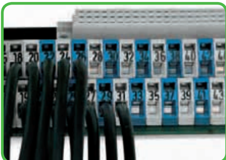
Клеммные колодки, размещенные друг за другом, экономят пространство – смещение их на половину шага контактов упрощает последовательное подключение на первом ряду.
