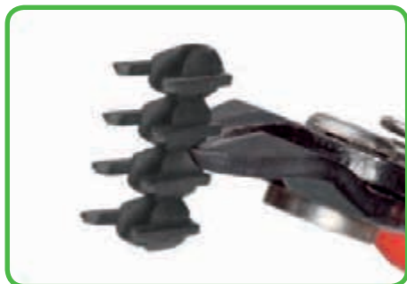
Разрежьте защитную вставку на необходимое количество полюсов. Не используйте однополюсные вставки!
