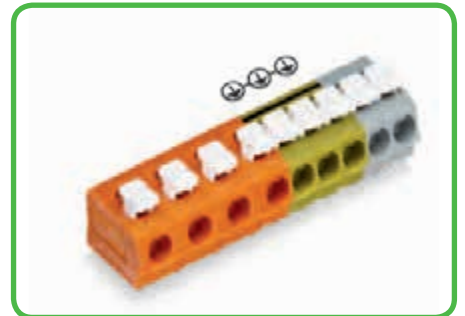
Клеммные колодки серии 804 обеспечивают «внутреннее объединение», чтобы отвечать требованиям и не прокладывать заземляющий проводник над платой. Это позволяет объединять и маркировать клеммные колодки на заводе по требованию заказчика.
