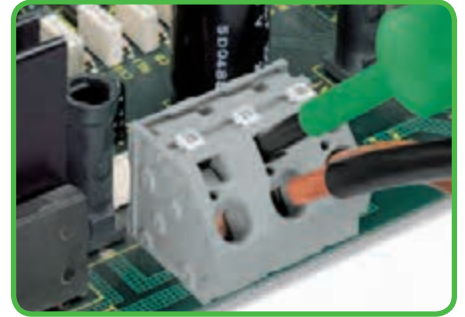
Вставка / извлечение проводника при помощи отвертки размером 5,5 мм - Серия 745, 16 мм 2 .
