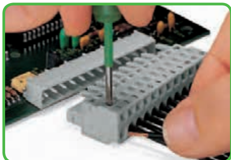
Подсоединение проводников при помощи отвертки 3,5 x 0,5 мм – перпендикулярно входу проводника.
