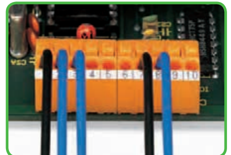
Расстояние между выводами может быть сохранено в сборке.
