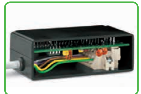
Угловая розетка и вилка с прямыми выводами под пайку, используемые для горизонтального монтажа в узких корпусах.
