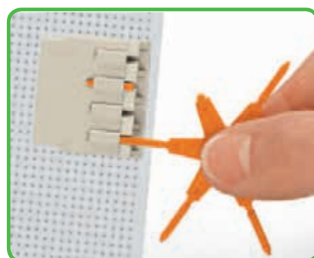
Кодирование вилки путем вставки кодировочного штифта.
