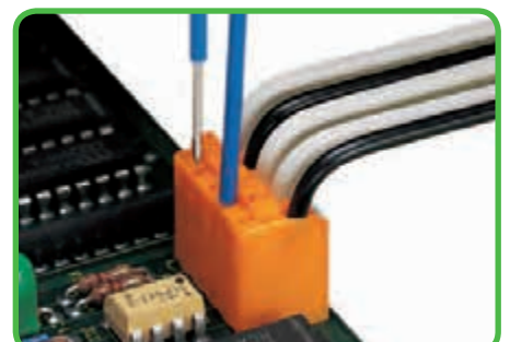
Тестирование при помощи тестового вывода Ø 1 мм.
