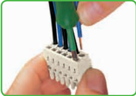
Вставка проводника при помощи отвертки 3,5 мм – горизонтальная работа зажима CAGE CLAMP®
