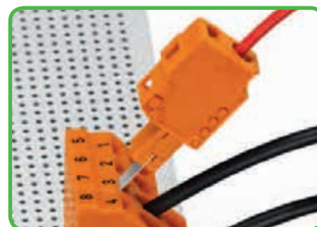
Модуль тестового штекера вставлен, с подключенными проводниками.
