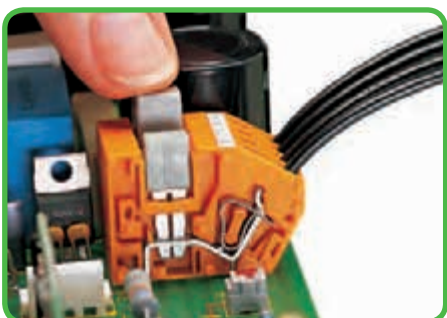
Объединение вертикальными поперечными перемычками. Перемычку всегда утапливайте до упора!
