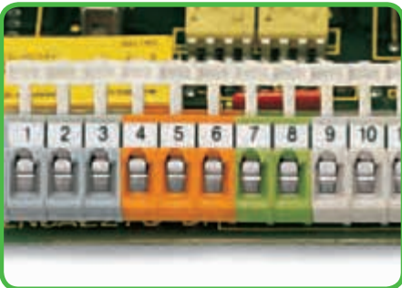
Формирование групп при помощи корпусов разных цветов.
