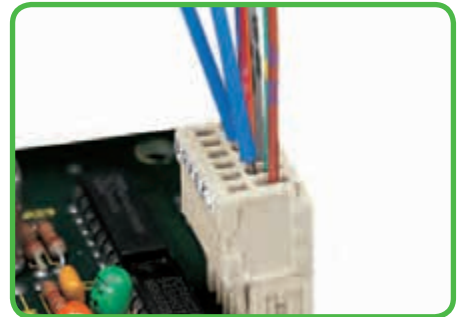
Тестирование при помощи тестового вывода Ø 1 мм (735-500), точечный контакт с токоведущей шиной.
