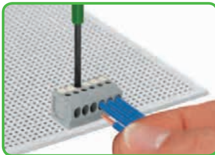
Подсоединение одножильных проводников простой вставкой в зажим. Вставка и извлечение тонкожильных проводников при помощи нажимных кнопок.
