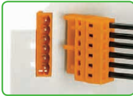
Сквозная вилка в малом отверстии. Кодирование при помощи кодировочных отверстий. Оставьте кодировочные штифты на розетке в позиции кодовых отверстий. Выломайте оставшиеся штифты.
