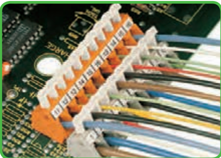
Возможное применение проводника со смещенными клемными колодками (только для серии 256).
