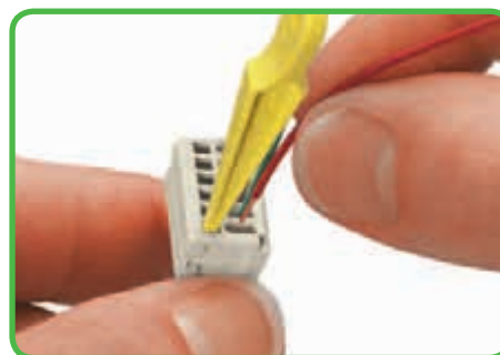
Вставка проводника при помощи рабочего инструмента 233-331. Ввод параллельно входу проводника.
