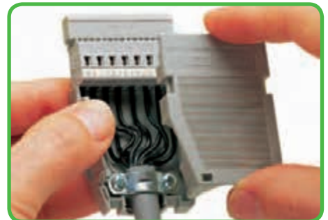
Защелкивание корпуса с разгрузкой натяжения, показано на примере вилки. Выходы кабеля по всей длине. Разгрузка натяжения кабельным зажимом.
