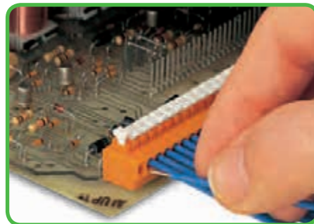
Монтаж одножильного проводника путем вставки в зажим.
