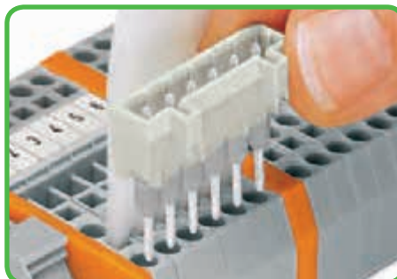
Рабочий инструмент, используемый с клеммами серии 280, монтируемыми на DIN-рейку: для вставки вилок и розеток с длинными контактными выводами в клеммы серии 280 (максимальное кол-во полюсов для монтажа в производственных условиях - 10). Рабочий инструмент, используемый с вилками и розетками CAGE CLAMP® (шаг контактов 5/5,08 мм): Для открытия до 10 зажимов CAGE CLAMP® одновременно, например, когда необходимо подсоединить гребешковые перемычки серии 231-90х. Монтаж вилок и розеток должен выполняться с использованием подходящего крепления.
