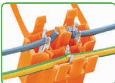
Соединение обеих половинок розетки приводит к автоматическому обрезанию и монтажу «опасного» провода без зачистки, что делает возможным переключающееся применение (например, в дверном переключателе).
