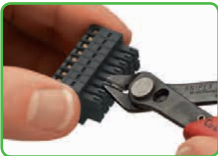
Кодирование розетки посредством извлечения кодировочных штифтов.
