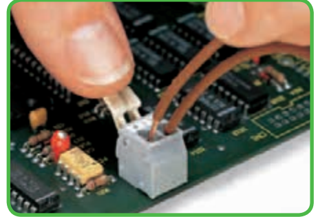
Вставка / извлечение проводника при помощи рычага, приводимого в действие пальцами - Серия 255.
