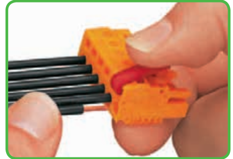
Вставка проводника в устройство CAGE CLAMP® при помощи рабочего рычага 231-291.
