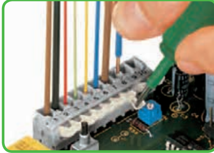
Вставка / извлечение проводника при помощи нажимной кнопки - Серия 255.
