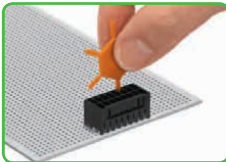
Кодирование вилки посредством вставки кодировочного штифта.
