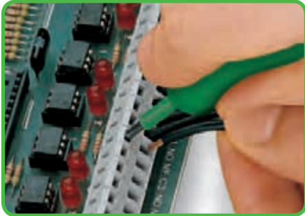
Вставка проводника при помощи 3,5 мм отвертки. Поместить отвертку параллельно входу проводника.
