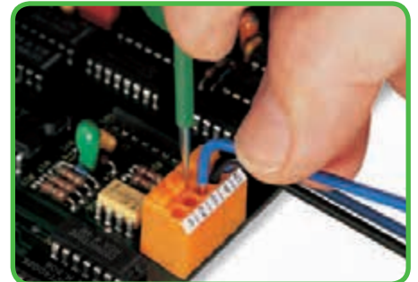
Извлечение проводника при помощи нажимной кнопки.
