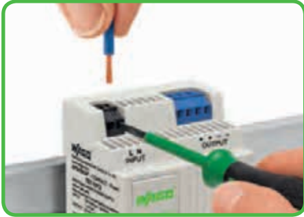
Вставка проводника перпендикулярно движению отвертки - Серия 740.
