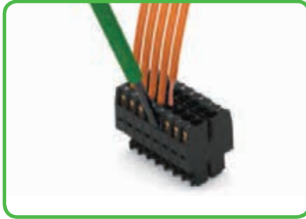
Вставка проводника при помощи (2,5 x 0,4) мм отвертки.
