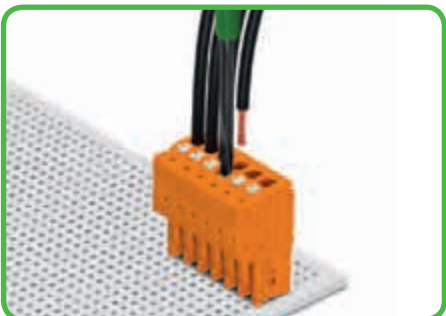
Вставка тонкожильного проводника в CAGE CLAMP®S при помощи нажимной кнопки; одножильные проводники можно просто вставить.
