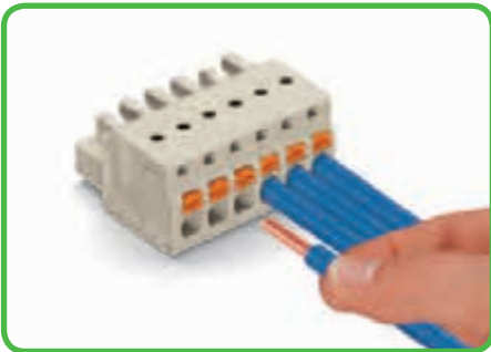
Монтаж одножильных проводников или проводников с наконечниками в зажим CAGE CLAMP®S без инструмента, простой вставкой.
