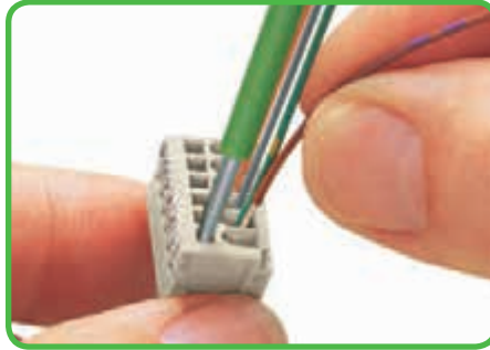
Вставка проводника при помощи отвертки (2,5 x 0,4) мм - применение CAGE CLAMP® параллельно вводу проводника.
