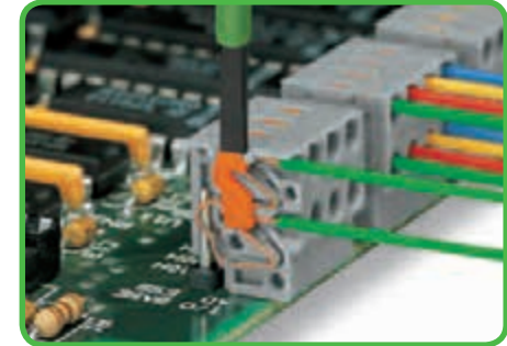
Отсоединение проводников нажатием кнопки – серия 252
