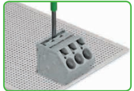
Чтобы вставить гребешковую перемычку, надавите на неё до упора при помощи отвертки - Серия 745.
