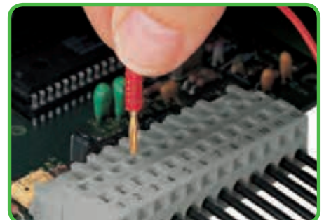
Тестирование перпендикулярно вводу проводника при помощи тестовых штекеров Ø 2 мм или Ø 2,3 мм – розетка с CAGE CLAMP®.
