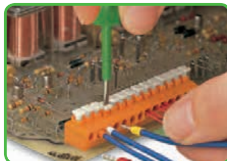
Вставка / извлечение тонкого многожильного проводника с наконечником при помощи нажимной кнопки.
