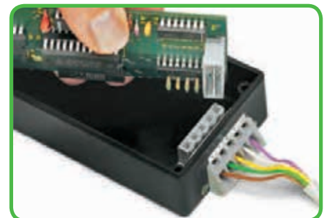
Угловая розетка, используемая как соединитель для сквозного монтажа. Порты и рабочие разъемы для монтажа расположены вне корпуса. Толщина панели до 2 мм/0,079 дюйма. На рисунке изображен шаг контактов 5 мм/0,197 дюйма.
