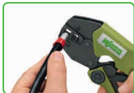
Вставьте проводник с наконечником в участок обжима.
