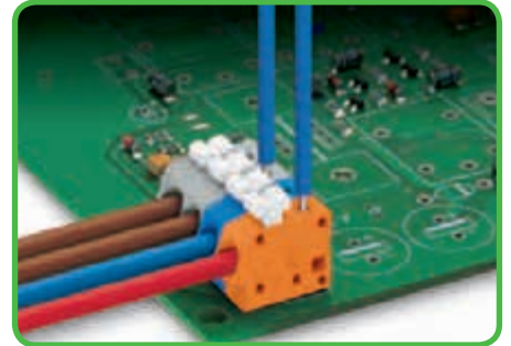
Тестирование при помощи тестовых выводов Ø 1 мм, точечный контакт с токоведущей шиной.
