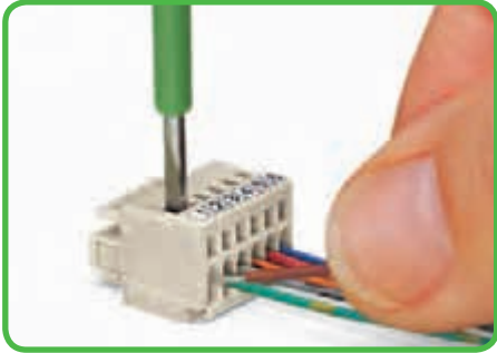
Вставка проводника при помощи отвертки (2,5 x 0,4) мм - применение CAGE CLAMP® перпендикулярно вводу проводника
