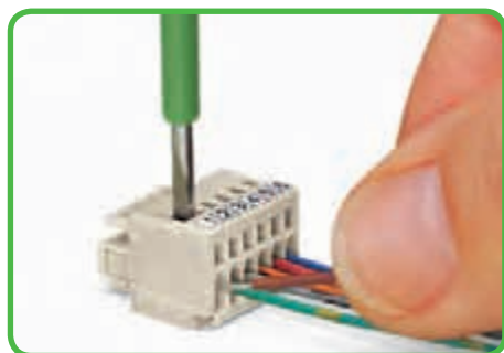
Вставка проводника при помощи (2,5 x 0,4) мм отвертки. Подсоединение перпендикулярно вводу проводника.
