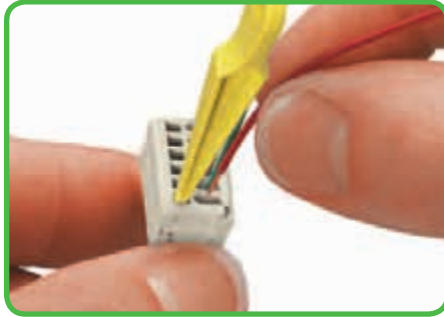
Вставка проводника при помощи рабочего инструмента 233-331. Рабочий инструмент вставляется параллельно вводу проводника.
