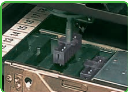
Вилки THR для пайки оплавлением припоя, для поверхностного монтажа.
