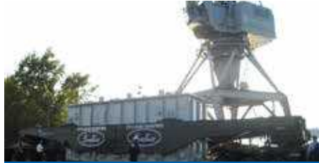
Сербия: трансформатор 400kV 400MVA
