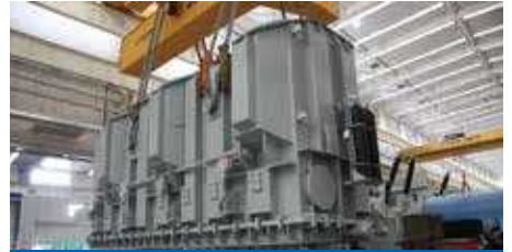
Пуэрто-Рико: трансформатор USA230kV 570MVA
