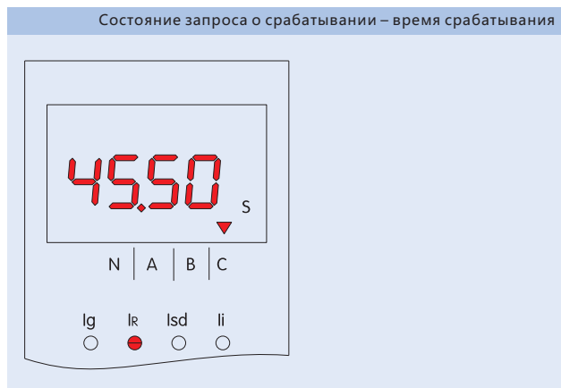
Состояние запроса о срабатывании – время срабатывания
