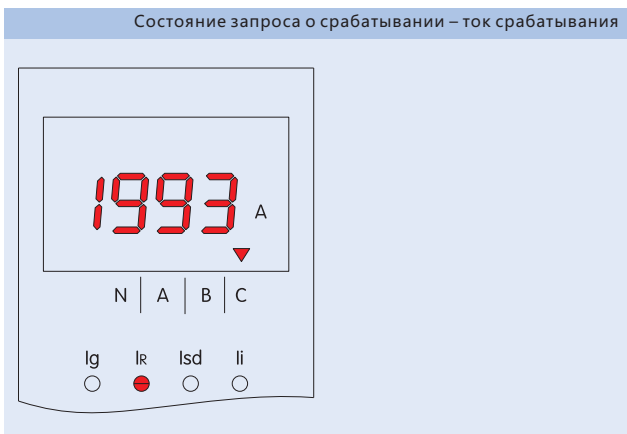
Состояние запроса о срабатывании – ток срабатывания
