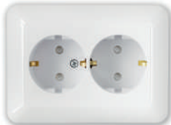
PC16-384 Розетка двухместная с з/к со шторками. Установка в одноместную коробку, 110x80x39,1 мм
