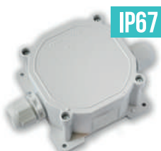
KM-253 (2 ввода) Коробка для разводки проводов IP67 и УХЛ2 Размер коробки: D 75,7 h 44,5 мм Габаритный размер: 130x78,5x44,5 мм
