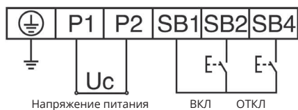
Схема подключения мотор-редуктора
