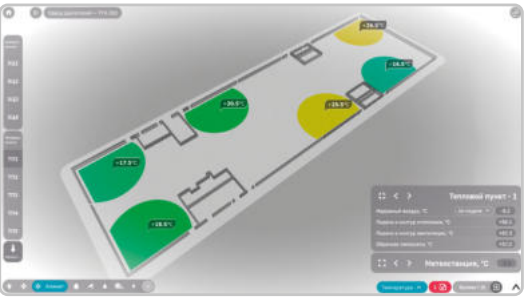
Тепловая карта и показания датчиков температуры
