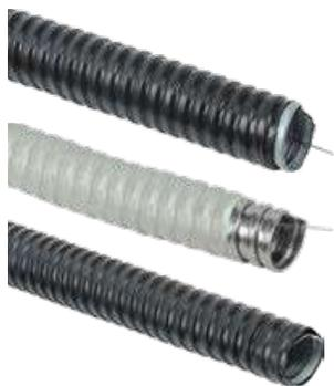
Гибкие металлорукава, произведенные из оцинкованной ленты, в ПВХ-изоляции, не поддерживающей горение. Предназначены для механической защиты электрических или информационных кабелей. В типе «с протяжкой» поставляются с металлической оцинкованной проволокой, предназначенной для удобства монтажа кабелей внутри металлорукава.
