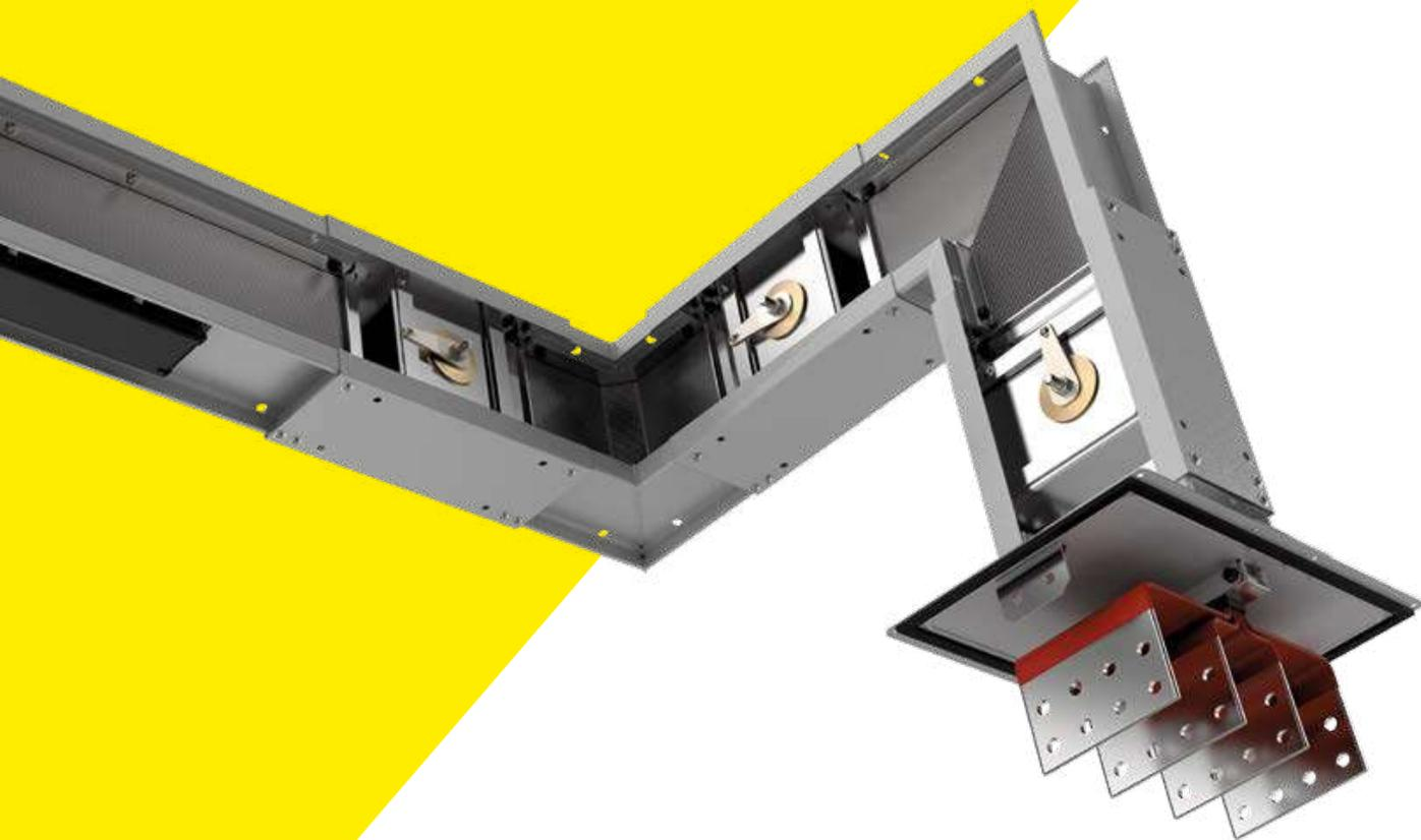
Шинопровод – это устройство для передачи и распределения электроэнергии средней и высокой мощности. Состоит из неизолированных или изолированных проводников (жестких шин), а также изоляторов, защитных оболочек, ответвительных устройств, поддерживающих и опорных конструкций. Поставляется комплектными секциями.
