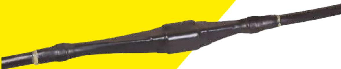
Муфты термоусаживаемые ПСттбэ-1 предназначены для соединения алюминиевых или медных жил кабелей с пластмассовой, резиновой и полиэтиленовой изоляцией с броней или экраном на напряжение 1 кВ: АВБ6Шв-1, ВБ6Шв-1, АВВБ-1, АВВБГ-1, ВВБ-1, ВВБГ-1, АПвБ6Шв-1, ПвБ6Шв-1, ВВГЭ, АВВГЭ, ПвВГЭ, АПвВГЭ, их аналогов и модификаций.
