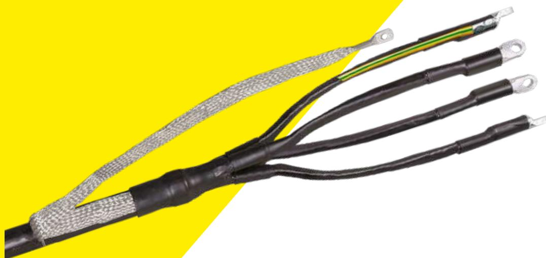
Концевые муфты для кабелей с пластмассовой изоляцией, с изоляцией из сшитого полиэтилена с броней или экраном ПКВ(Н)тпбэ-1 и ПКВтпбэ-1 предназначены для оконцевания алюминиевых или медных жил кабелей с пластмассовой, резиновой и полиэтиленовой изоляцией с броней или экраном на напряжение 1 кВ: АВБ6Шв-1, ВБ6Шв-1, АВВБ-1, АВВБГ-1, ВВБ-1, ВВБГ-1, АПвБ6Шв-1, ПвБ6Шв-1, ВВГЭ, АВВГЭ, ПвВГЭ, АПвВГЭ, их аналогов и модификаций.
