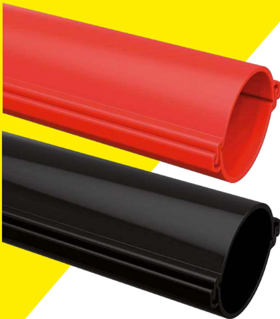
Предназначены для прокладки силовых кабелей, информационных и сигнальных линий связи в земле и защиты их от механических повреждений. Состоят из двух одинаковых частей, при монтаже кабель укладывается на нижнюю часть трубы, верхняя часть защелкивается. Соединение труб производится перекрытием верхней части относительно нижней примерно на 30 см.
