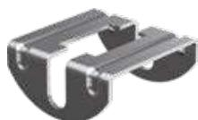
Применяется для монтажа кабельных трасс к потолку на шпильках, чтобы предотвратить излом шпильки в случае раскачивания кабельной трассы.
