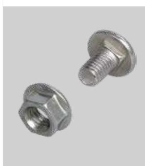
Для соединения кабельных лотков между собой и с аксессуарами используется универсальный соединительный комплект КС М6×10. Благодаря квадратному подголовнику, фиксирующему винт, для монтажа кабельной трассы потребуется только один ключ на 10 мм.
