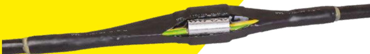
Соединительные муфты для кабелей с пластмассовой изоляцией, с изоляцией из сшитого полиэтилена ПСтт-1 предназначены для соединения алюминиевых или медных жил кабелей с пластмассовой, резиновой и полиэтиленовой изоляцией на напряжение 1 кВ: АВВГ-1, ВВГ-1, АВВГз-1, ВВГз-1, АПВВГ-1, ПВВГ-1, их аналогов и модификаций.
