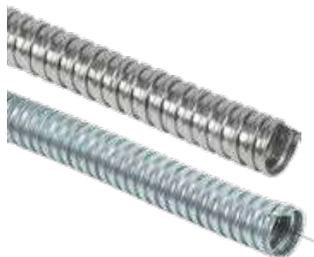
Металлорукава типа P3-ЦХ – гибкие металлорукава, произведенные из оцинкованной ленты с уплотнением хлопчатобумажным шнуром, с протяжкой и без. Предназначены для механической защиты электрических или информационных кабелей. В типе «с протяжкой», поставляются с металлической оцинкованной проволокой, предназначенной для удобства монтажа кабелей внутри металлорукава.
