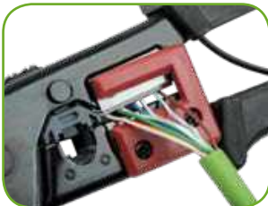
Регулируемые ножи из нержавеющей стали для зачистки и обрезки кабеля
