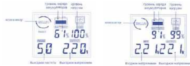
Индикация дисплея в батарейном режиме
