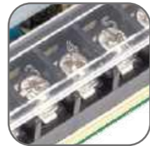
Сдвоенные клеммы питания для удобного подключения
