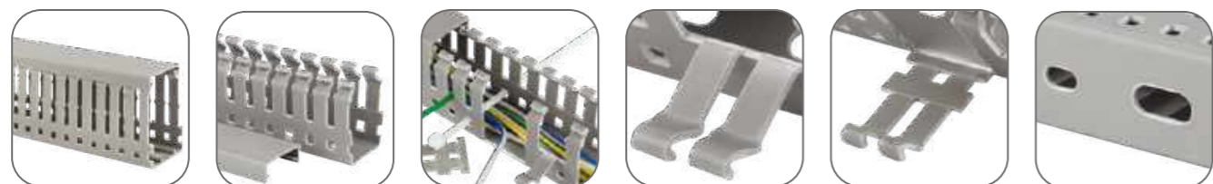
Материал изделия ПВХ Шаг перфорации совпадает с шагом контактных зажимов на модульной аппаратуре Отверстия под стяжки для крепления проводов Специальная линия отлома зубца Специальная линия отлома секции Отверстия в основании разного диаметра
