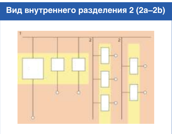
Отделение сборных шин от всех функциональных блоков
