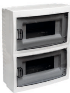
КНО-16Д (открытая установка) Бокс для 16-ти автоматических выключателей, 267,7x212x104 мм
