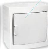
КНО-4Д (открытая установка) Бокс для 4-х автоматических выключателей, 147,7x140x100 мм
