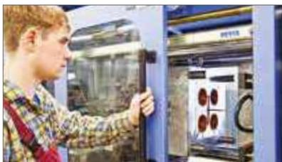
Термопластавтоматы для производства литых изделий
