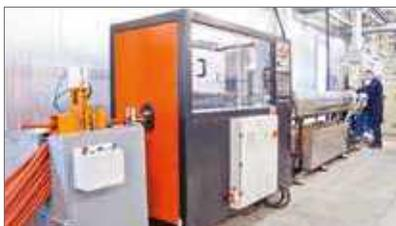
Линии для экструдирования термоусаживаемой трубки
