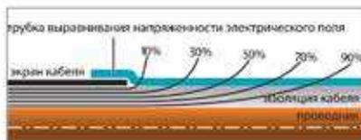
Конструкция кабельных муфт на напряжение выше 6 кВ требует обязательного учета дополнительных факторов, не проявляющихся на низких напряжениях.
