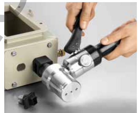
Пробивка отверстий для различных промышленных разъемов Ethernet.
