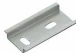
TS 35/7,5 мм согласно EN 50022 (s = 1,0 мм)
