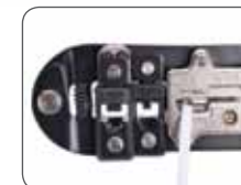
Зачистка плоского провода
