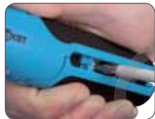
Зачистка коаксиального кабеля
