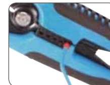
Опрессовка изолированного наконечника
