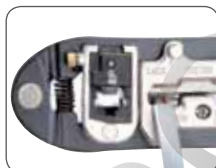
Зачистка плоского провода
