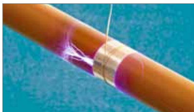
Определение электрической прочности материалов
