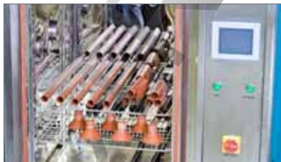
Испытания в климатической камере
