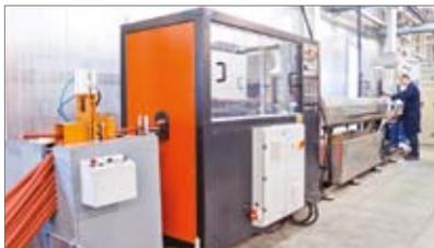
Линии для экструдирования термоусаживаемой трубки
