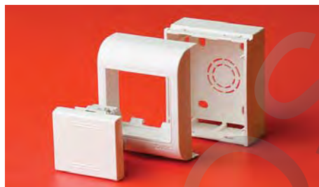
1. Коробки типа PDD для электроустановочных изделий "Viva", "Brava", 45x45 мм. В данные коробки розетки монтируются защелкиванием (без рамок и каркасов). С 4-х сторон коробки имеют перфорацию под все типоразмеры миниканалов серии TMC
