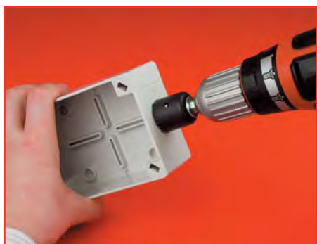
Сверлим отверстия необходимого диаметра
