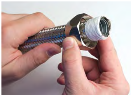
1. Вначале следует одеть на металлорукав зажимную гайку
