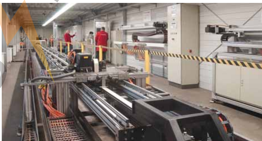
Испытание кабелей для буксируемых цепей
