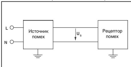
**Симметричное напряжение - differential mode voltage; symmetrical voltage**
