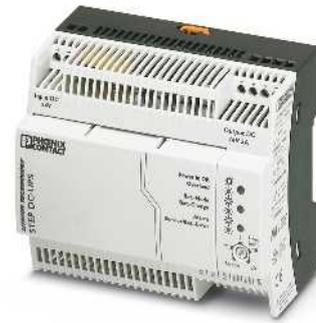
Источник бесперебойного питания со встроенным аккумулятором
