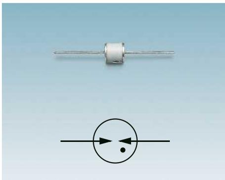
Газонаполненный разрядник представляет собой устройство с электродами, помещенными в керамическую или стеклянную трубку. Между электродами находится инертный газ, напр. аргон или неон. При достижении напряжения пробоя сопротивление между электродами становится близким к нулю в следствие разряда в газе. Напряжение пробоя не является постоянной величиной, оно зависит от скорости нарастания перенапряжения.
