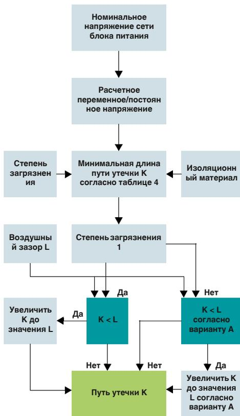
Однофазные трех- или двухпроводные системы переменного или постоянного тока (выдержка из таблицы 3а)
