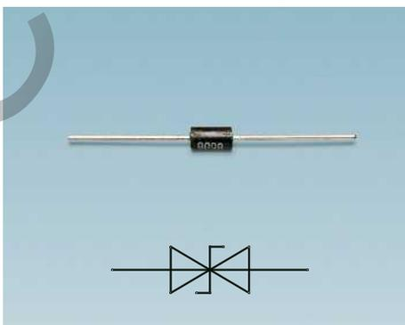
Обратное запирающее напряжение  $U_R$  - это максимальное напряжение, при котором ток через диод еще не течет. При напряжении пробоя  $U_B$  через ограничительный диод начинает течь ток  $1$  мА. В этом случае ограничительный диод начинает ограничивать перенапряжение.
