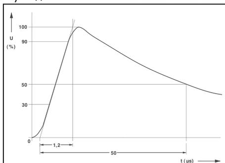
Импульс напряжения формы 1,2/50 согласно МЭК 60060-1
