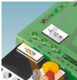
Наклеиваемая маркировка для оборудования, возможность гравирования или печати GPE...
