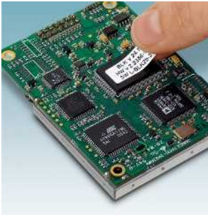
Наклеиваемая маркировка оборудования, с возможностью отклеивания, печать с помощью THERMOMARK ROLL... EML-RM...
