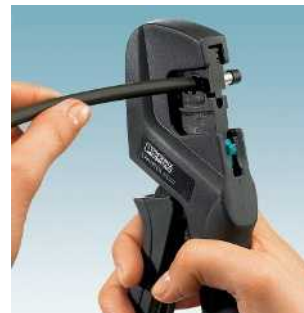
Основные клещи для установки различ- ных коаксиальных обжимных матриц CRIMPFOX-M...
