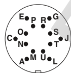
Расположение контактов разъема M16, 14-полюсн.
