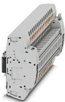
6 (10) мм 2 , 30 А, 4 ... 25-конт. базовый блок, установка на монтажную рейку, зажим push-in
