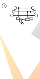
28 А, трехъярусная клемма со световым индикатором
