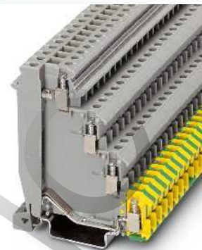
2,5 (4) мм 2 , 26 А, четырехпроводная клемма для датчиков с основанием PE
