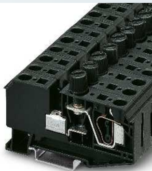
10 А, клемма с держателем предохранителя (для стеклянных предопр.) 5 x 20 мм
