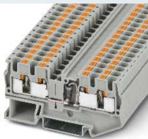
1,5 А, диодная клемма, 1N 5408 (1000 В/1,5 А)
