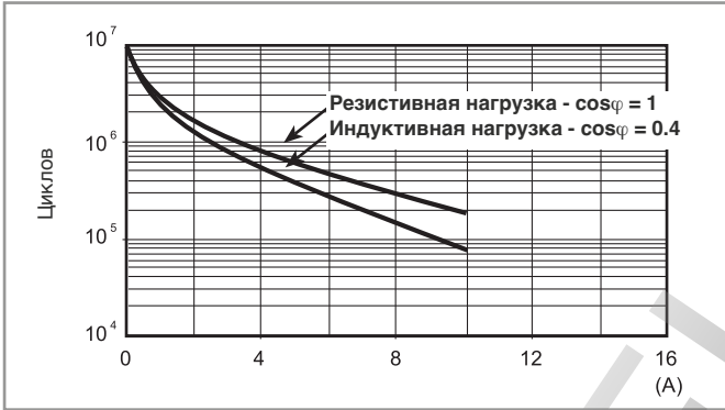
F 40 - Электрическая долговечность (АС) при ном. нагрузке Типы 40.11
