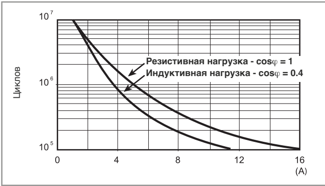
H 62 - Макс. отключающая способность DC1 Перекидные контакты
