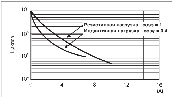
F 36 - Электрическая долговечность (АС) при ном. нагрузке
