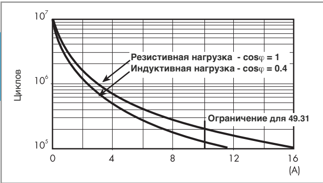
F 49 - Электрическая долговечность (AC) при ном. нагрузке, Типы 49.31/61/81
