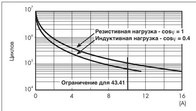
F 43 - Электрическая долговечность (АС) при ном. нагрузке
