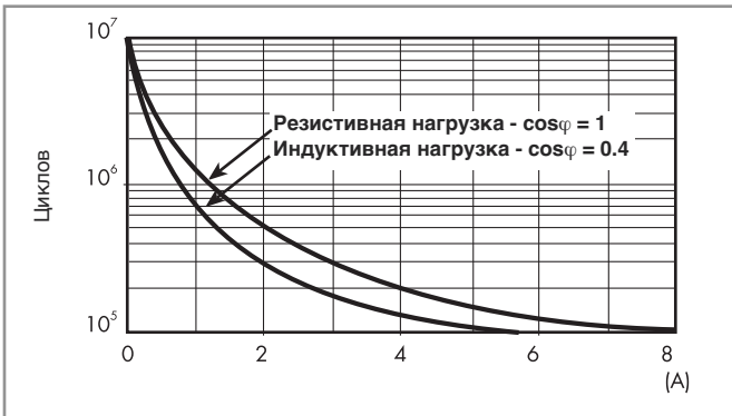
F 50 - Электрическая долговечность (AC) при ном. нагрузке
