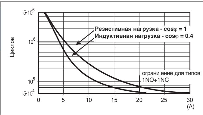
F 65 - Электрическая долговечность (AC) при ном. нагрузке
