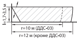
ДДС Зона обнаружения по вертикали (вид сбоку)
