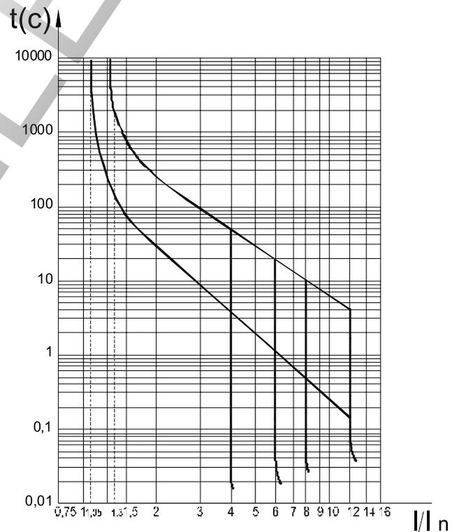
Выключатели с электромагнитными и тепловыми расцепителями с уставкой по току срабатывания  $5I_n, 10I_n$  при температуре  $30\text{ }^{\circ}\text{C}$ .
