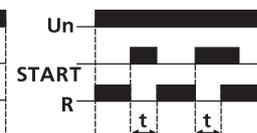
**К) Блокировка включения реле на время t**
