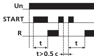
**Д) Задержка включения реле после сигнала START**
