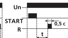
**И) Формирователь импульса по заднему фронту управляющего сигнала**
