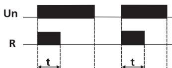
При включении питания включается реле, замыкаются контакты 11–12. После отсчёта установленной выдержки времени реле отключается и в таком положении остаётся до отключения питания.
