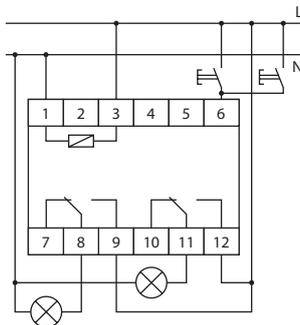
Кнопки управления подключены к фазному проводу L.
