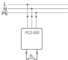
С функцией реле напряжения.
