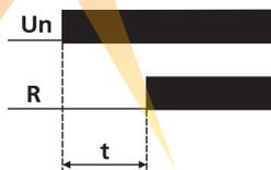
После включения питания и отсчёта установленной выдержки времени реле включается, замыкаются контакты 11–12. В таком положении реле находится до отключения питания.
