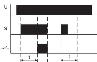
При замыкании контакта S начинается отсчёт выдержки времени, по истечении которой включается исполнительное реле (замыкаются контакты 11–12). В таком положении реле находится до отключения питания или размыкания контакта S. Если разомкнуть контакт S до истечения выдержки времени, отсчёт прекращается. При замыкании контакта S отсчёт начинается снова.
