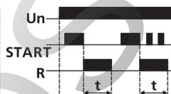
**Г) Формирователь импульса по заднему фронту управляющего сигнала**
