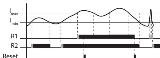
**Функция С:** если ток больше  $I_{\min}$ , замкнуты контакты реле R2, если ток больше  $I_{\max}$ , замкнуты контакты реле R1. Реле R1 блокируется до момента нажатия кнопки RESET на лицевой панели.
