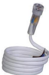
Светочувствительный малогабаритный фотодатчик в герметичном пластмассовом корпусе с проводом длиной 1 метр и гайкой для крепления на плоскости (в щит). Возможно удлинение провода до 50 м. Поставляется в комплекте с автоматами AZH-S, AZ-B, AZ-112, AWZ-30-10/38.
