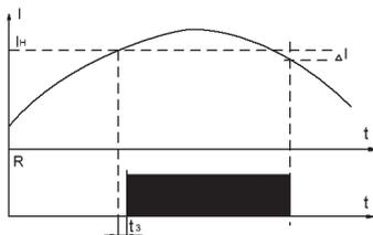
При превышении установленного значения реле переключается через время задержки (контакты 7–9 разомкнуты, 8–9 замкнуты). При снижении тока на величину гистерезиса (10 %) реле возвращается в исходное состояние (контакты 7–9 замкнуты, 8–9 разомкнуты).  $I_H$  – максимальное значение тока.
