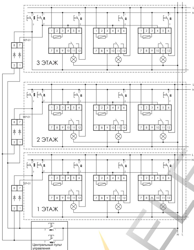
**Z0** – кнопочные выключатели, управляющие каждой лампой в отдельности (включение/выключение).
