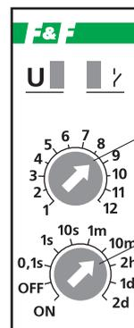
Регулятор плавной установки времени
