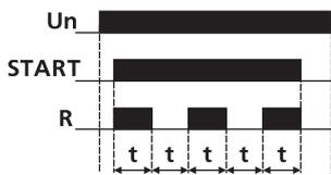
**С) Генератор импульсов с длительностью импульса, равной длительности паузы (уставка реле). Работа происходит при наличии напряжения на входе START**
