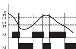
Работа в режиме "Окно": реле K1 включено, если температура в пределах от T1 до T2; K2 включено, если температура вышла за пределы T1 и T2.
