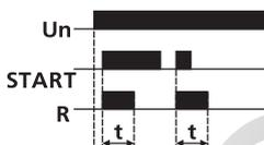
**Ф) Формирователь импульса по переднему фронту управляющего сигнала**
