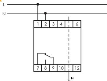
4-функциональное, с регулируемым верхним и нижним порогом срабатывания.
