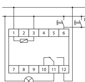
Кнопки управления подключены к нулевому проводу N.
