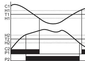
Два независимых терморегулятора, работающих в режиме охлаждения.
