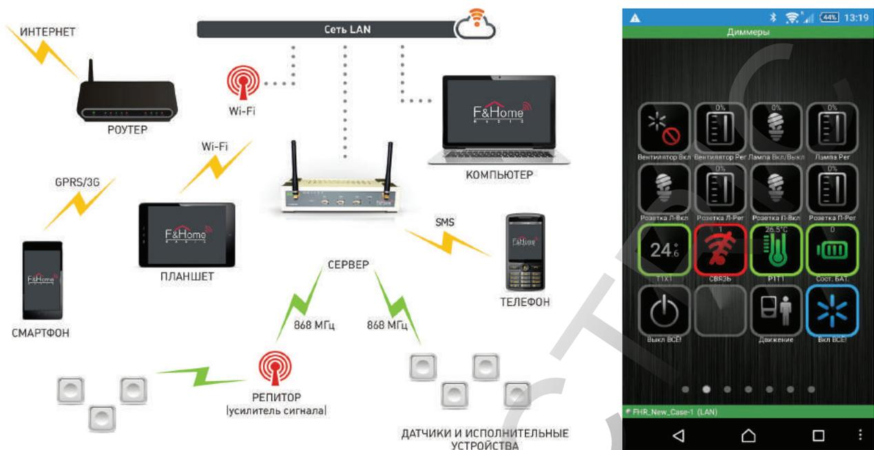
F&Home Radio может распознавать аварийные ситуации по сигналам от сторонних датчиков (протечка воды, пожар, утечка газа, тревога охранной сигнализации, поломки инженерного оборудования и т.д.). По возможности система ликвидирует их и сообщает об этом владельцу на мобильное устройство.
