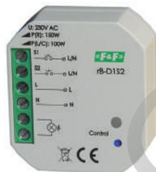
Контроль и управление источниками освещения (включение/выключение, плавная регулировка яркости) мощностью до 150 Вт (резистивная нагрузка) и до 100 Вт (индуктивная и ёмкостная нагрузка). Установка в монтажную коробку.
