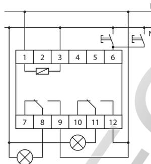
Кнопки управления подключены к нулевому проводу N.
