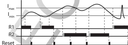
**Функция Д:** если ток меньше  $I_{\min}$ , замкнуты контакты R1. При достижении значения тока  $I_{\max}$  замыкаются контакты R2. Контакты реле блокируются до момента нажатия кнопки RESET на лицевой панели.
