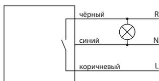
Герметичный со встроенным фотодатчиком. Крепится двумя шурупами на плоскость.
