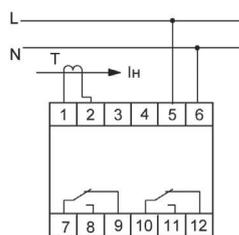
4-функциональное, с регулируемым верхним и нижним порогом срабатывания. При токе более 5 А применяется с ТТ.
