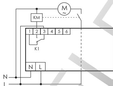
Для защиты однофазных электродвигателей мощностью от 0,6 до 5 кВт.
