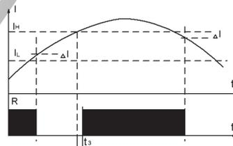
Реле срабатывает при выходе тока за установленные значения (закрываются контакты 8–9, контакты 7–9 разомкнуты).
