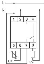
Датчик температуры заключён в отрезок термоусаживаемой трубки, поставляется с проводом длиной 2,5 м сечением 0,5 см<sup>2</sup> в двойной изоляции. Клеммы подключения датчика изолированы от сети питания и контактов исполнительного реле.
