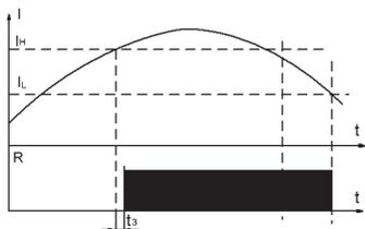
При превышении тока верхнего значения срабатывает реле (контакты 7–9 разомкнуты, 8–9 замкнуты). При снижении тока меньше нижнего порога реле возвращается в исходное состояние (контакты 7–9 замкнуты, 8–9 разомкнуты).
