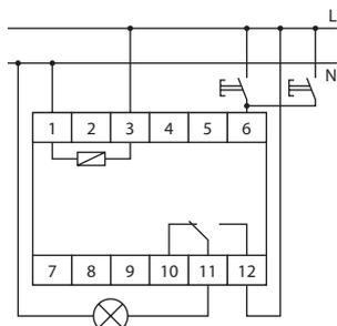
Кнопки управления подключены к фазному проводу L.
