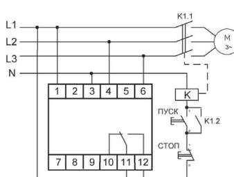
Регулируемые задержка отключения и порог асимметрии. Контроль нижнего и верхнего порогов напряжения.
