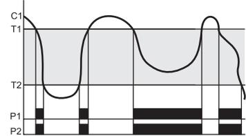
Переключение реле P1 и P2 в зависимости от температуры C1. Реле включены, если температура в пределах от T1 до T2.
