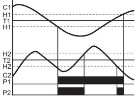
Реле P1 переключается в зависимости от температуры C1. Реле P2 переключается в зависимости от температуры C2 (включение только при включённом реле P1).
