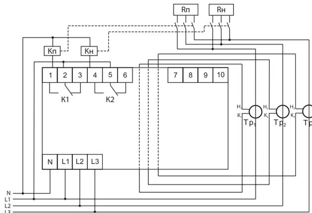
Кп, Кн — контакторы с нормально разомкнутыми контактами
