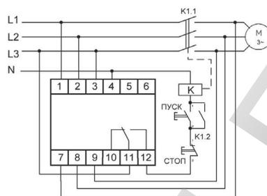
Регулируемый порог асимметрии. Контроль нижнего порога напряжения.
