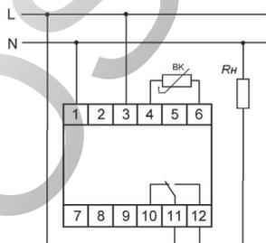
Датчик температуры имеет гальваническую связь со схемой питания!
