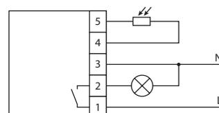
С выносным герметичным фотодатчиком. Крепится двумя шурупами на плоскость.
