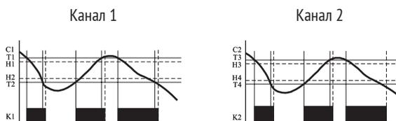
Два терморегулятора в режиме "Окно".
