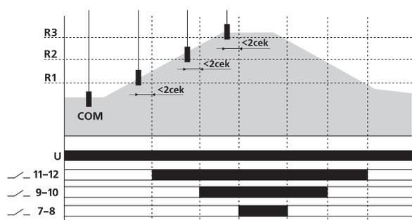
Применяются для контроля и поддержания заданного уровня электропроводящих жидкостей в резервуарах, бассейнах, водонапорных башнях и т. п. и управления электродвигателями насосных установок. Реле контролирует наличие жидкости на 3 уровнях. Может применяться как для контроля уровня электропроводящей жидкости на 3 уровнях одного резервуара, так и независимого контроля уровней жидкости одновременно в 2 или 3 резервуарах.
