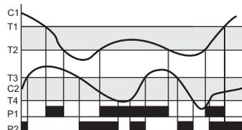
Реле P1 включено, если температура C1 в пределах от T1 до T2. Реле P2 включено, если температура C2 в пределах от T3 до T4.
