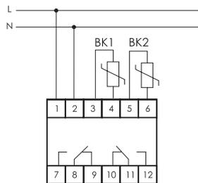
Два независимых канала с выносными датчиками температуры.
