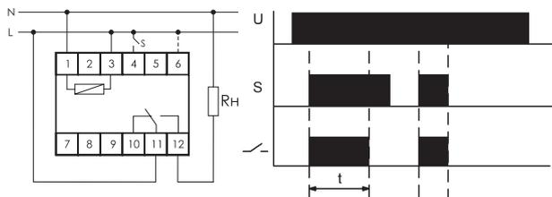
При замыкании контакта S включается исполнительное реле (закрываются контакты 11–12) и начинается отсчёт выдержки времени, по истечении которой реле выключается (размыкаются контакты 11–12). В таком положении реле находится до отключения питания. Если разомкнуть контакт S до истечения выдержки времени, отсчёт прерывается. При замыкании контакта S отсчёт начинается снова.
