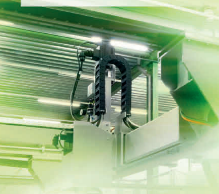
Робот Delta-2 — захват и перенос, управляемые контроллером Trajexia
