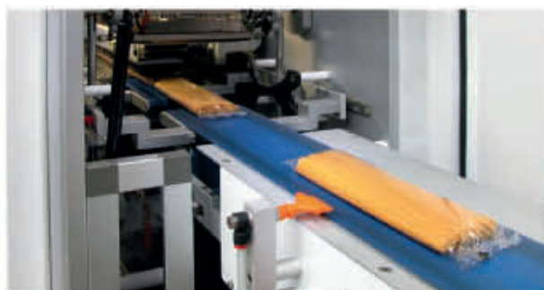
Машины непрерывной упаковки, управляемые контроллером Trajexia
