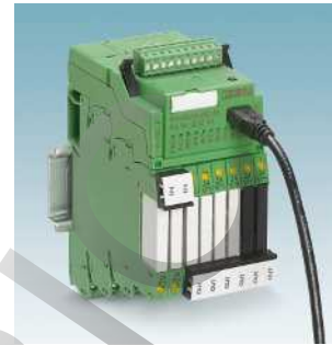
Программируемая система логических реле - PLC logic
