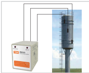
Автоматический контроль уровня воды в водонапорной башне.
