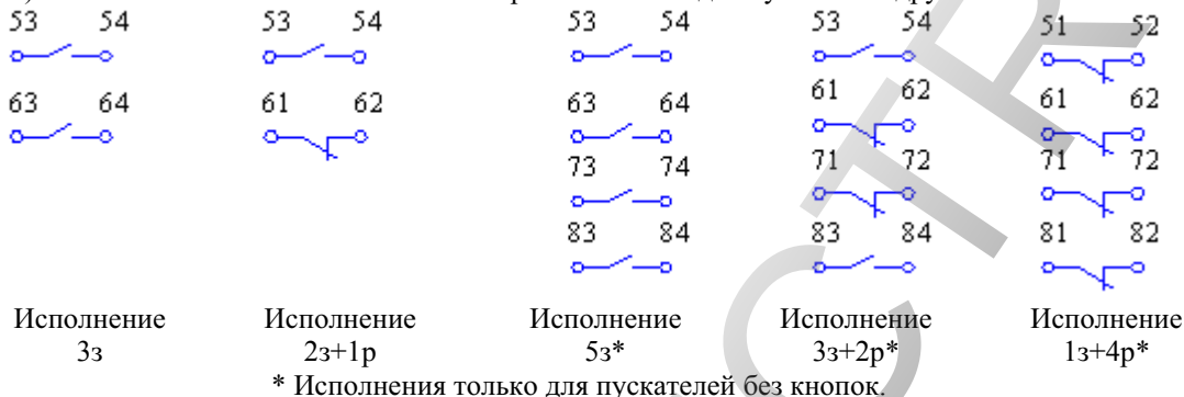
Рис. 2.17 - Пускатели неперевёрсивные типа ПМ12-025, ПМ12-040 без реле в оболочках степени защиты IP40, IP54
